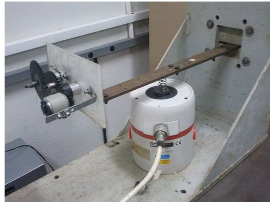
Shaker colocado em baixo da viga. A transmissão de movimento do shaker para a viga é dada por uma mola.
